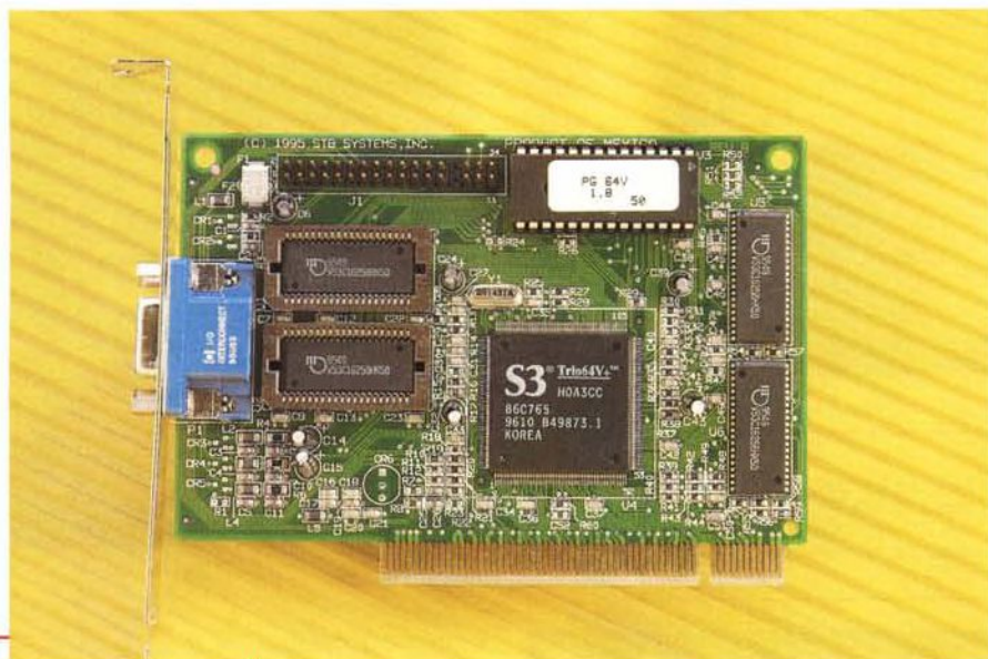
La costruzione della STB PowerGraph 64 Video ricalca perfettamente l'attuale produzione corrente; sono in evidenza la buona compattezza ed il layout. È ben visibile l'S3 Trio64+.
